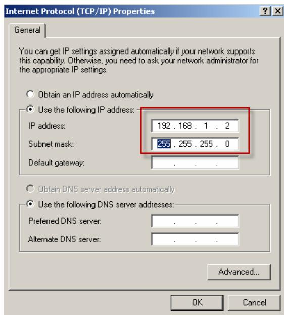
2. Pastikan koneksi ke Radio lancar dengan cara ping ke IP Address Radio. Ping 192.168.1.254 –t. **Jangan dilanjutkan jika diping belum bisa.!!**
